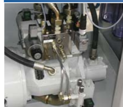
Robuste Antriebshydraulik mit Axialkolbenpumpe und separater Zahnradpumpe.
